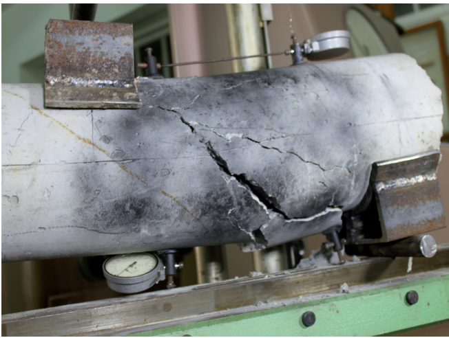
Рис.1. Колона кругового перерізу після проведення випробувань.
