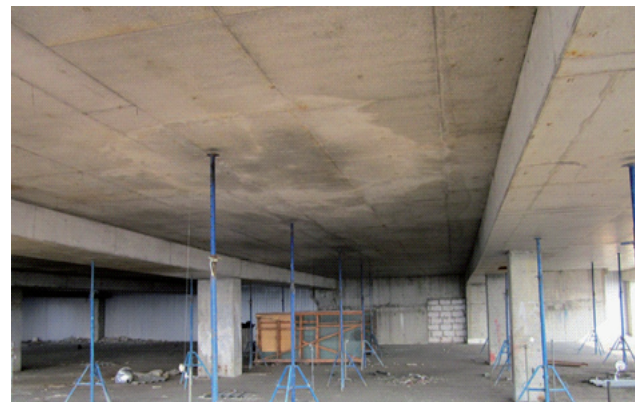
Рис.5. Вигляд фрагменту перекриття знизу під час випробувань.
