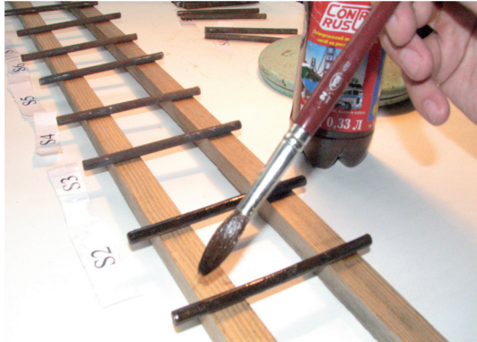
Рис.2. Обробка арматурних стрижнів перетворювачем іржі «Контраст».
