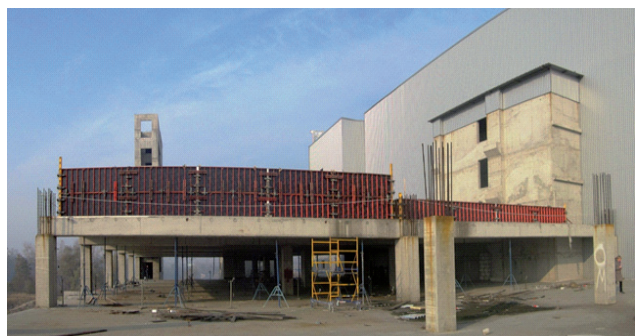
Рис.4. Випробування фрагменту перекриття другого поверху. Навантаження прикладається шляхом наповнення ємкостей водою: а – вигляд зверху, б - збоку
