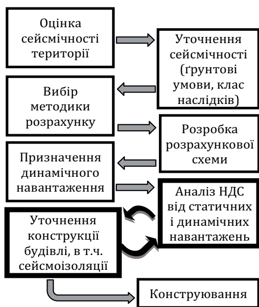
Рис. 1. Особливості проектування конструкцій в сейсмічно-небезпечних районах, загальна схема
