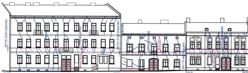
Рис. 2. Тріщиноутворення на фасадах житлових будинків старої забудови
