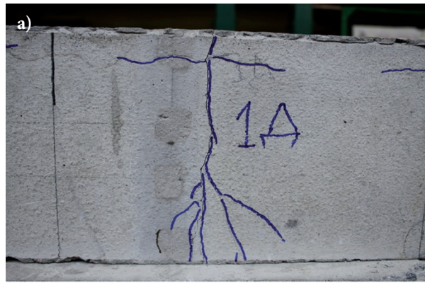
Рис. 3. Руйнування зразка балки, армованої стержнем базальтопластикової арматури Ø8, після 2 млн. циклів а) загальний вигляд зруйнованого зразка; б) крупний план руйнуючої тріщини
