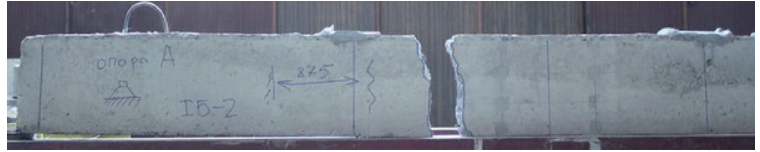
Рис. 1. Руйнування зразка балки, армованої стержнем базальтопластикової арматури Ø4, після 2 млн. циклів
