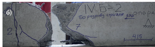
Рис. 4. Руйнування зразка балки, армованої стержнем базальтопластикової арматури Ø10, після 2 млн. циклів а) вигляд тріщини, що утворилася під час динамічного режиму навантаження; б) крупний план руйнуючої тріщини
