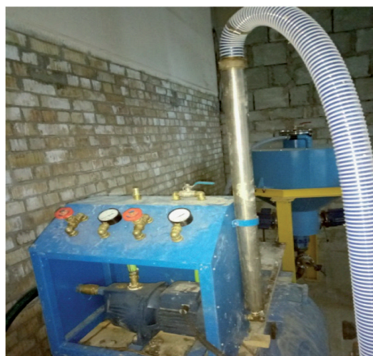
Рис. 1. Мобільна лінія з виготовлення пінобетонної суміші: а) – загальний вид; б) – кавітатор ударної дії; в) – змішувач; г) – піногенератор; д) – компресор
