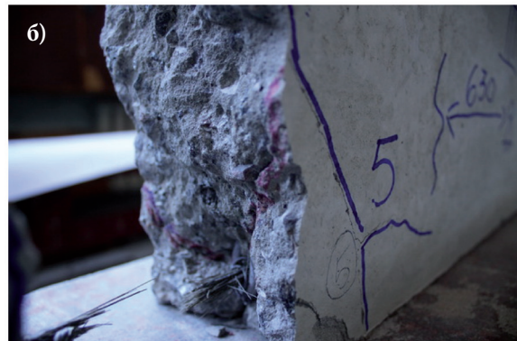
Рис. 3. Руйнування зразка балки, армованої стержнем базальтопластикової арматури Ø8, після 2 млн. циклів а) загальний вигляд зруйнованого зразка; б) крупний план руйнуючої тріщини
