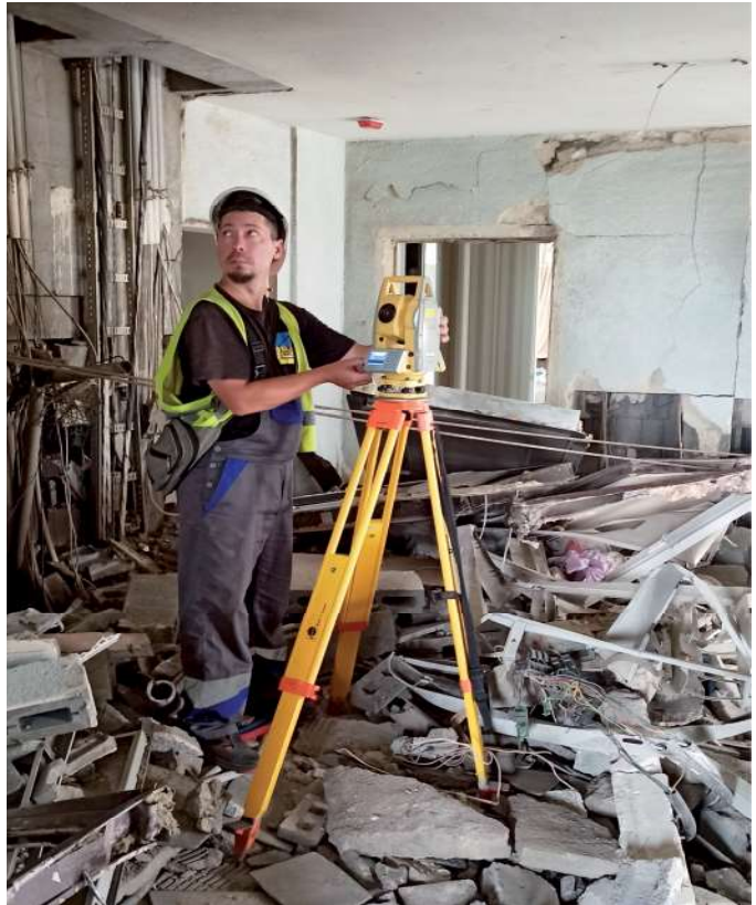
Рисунок 11 – Процес тригонометричного нівелювання у безвідбивачевому режимі
