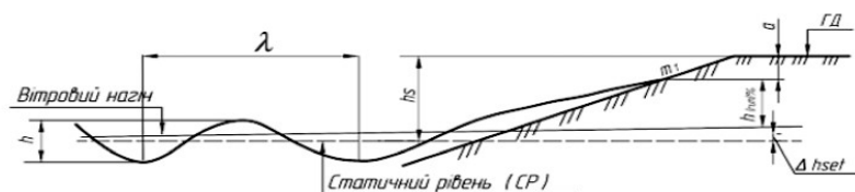
Рисунок 1 – Розрахункова схема для визначення відмітки верху греблі з ґрунтових матеріалів, дамби обвалування або насипу.
