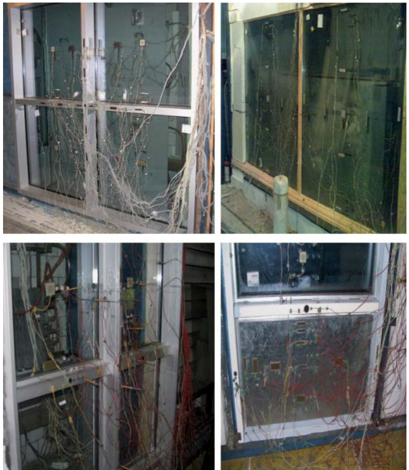
Рисунок 4 – Дослідження світлопрозорих огорожувальних конструкцій у кліматичній камері
