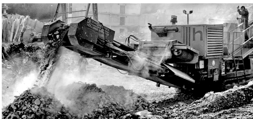
Рисунок 2 – Вторинний щебінь відвантажується в конуси після щокислового подрібнення та магнітної сепарації арматури
