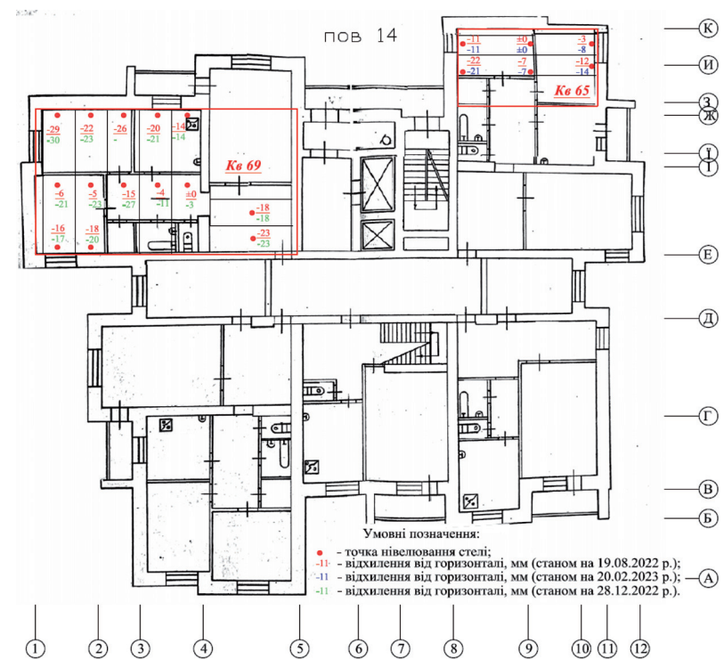
Рисунок 8 – Результати моніторингу прогинів перекриття методом геометричного нівелювання житлового будинку по вул. Генерала Белова, 27
