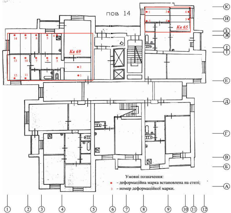
Рисунок 7 – Схема розташування деформаційних марок, встановлених на перекритті 14-го поверху житлового будинку по вул. Генерала Белова, 27
