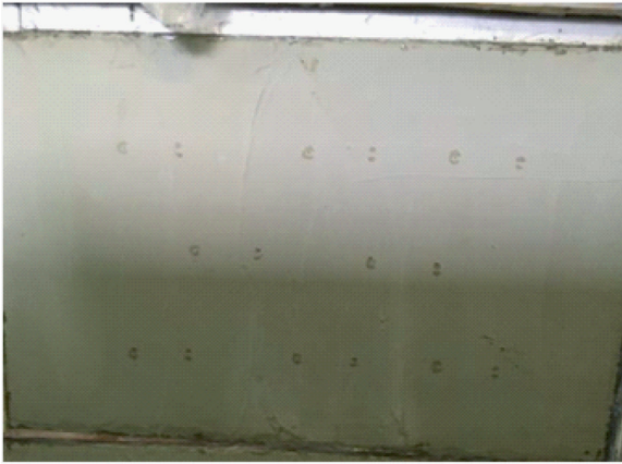
Рисунок 2 – Зовнішній вигляд дослідних зразків комплекту фасадної теплоізоляції після I-го етапу випробувань циклічних впливів
