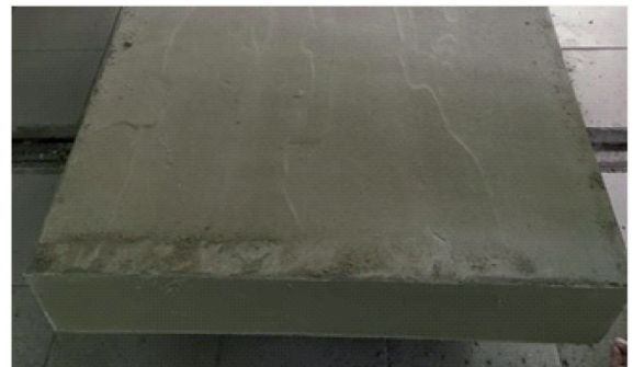
Рисунок 1 – Зразки комплектів у кліматичній камері виготовлених при температурі мінус 10^{\circ}\text{C}
