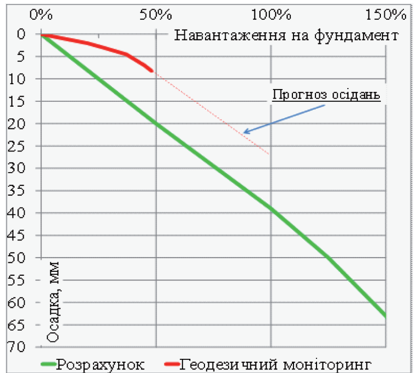
Рисунок 7 – Розрахункові осідання фундаменту та навантаження на барети
