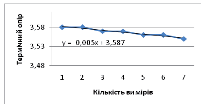
Рисунок 6 – Термічний опір зразків на пінополістирольній та мінераловатній основі
