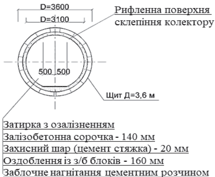
Рисунок 2 – Конструкція каналізаційного колектору
