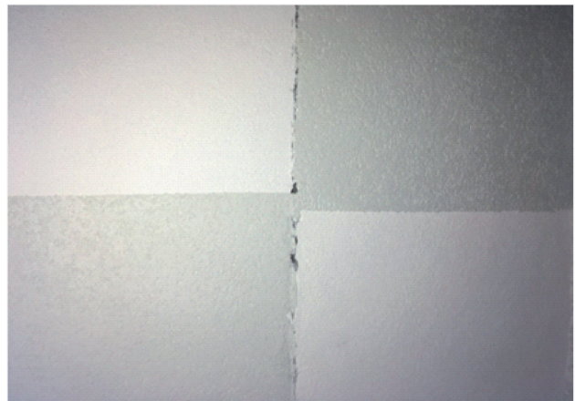
Рисунок 3 – Нанесення декоративних шарів на зразки комплектів
