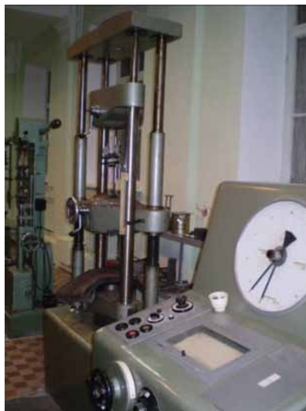
Рис.3. Общий вид испытаний механических соединений арматуры диаметром 12 мм с конической резьбой муфтами Lenton на разрывной машине ZD-40.
