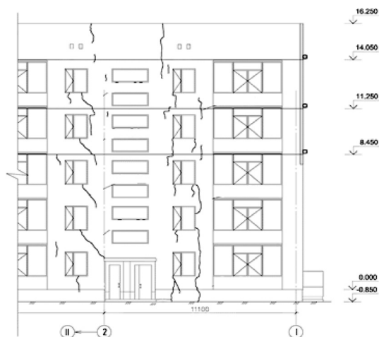
Рисунок 8 – Схема розміщення дефектів (тріщин) і пошкоджень у кладці зовнішніх стін на фасаді 2-I за даними геотехнічного моніторингу
