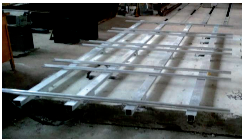
Рисунок 3 – Загальний вигляд каркасу зразка із алюмінієвих профілів
