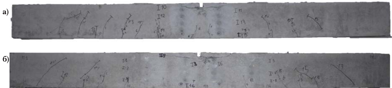
Рисунок 2 – Характер руйнування контрольних балок серії 2-ї, (а) зовнішня та (б) внутрішня сторона
