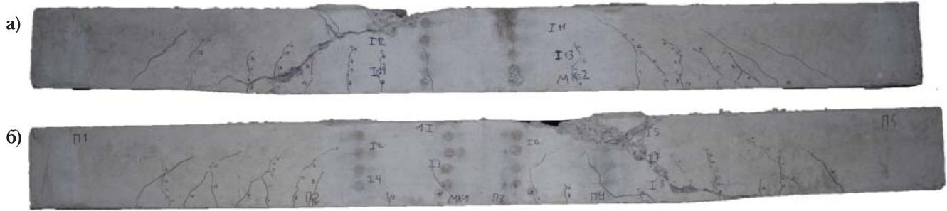
Рисунок 1 – Характер руйнування контрольних балок серії 1-ї, (а) зовнішня та (б) внутрішня сторона
