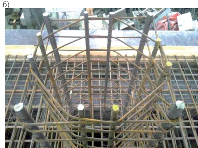
Рисунок 1 – Армування зразка балки: а) армування полиці б) армування опори-колони
