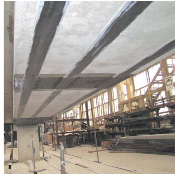
Рисунок 3 – Загальний вигляд зразка із підсиленням на стенді з навантажувальним обладнанням та вимірювальними приладами під час випробувань: а – з боків; б – знизу
