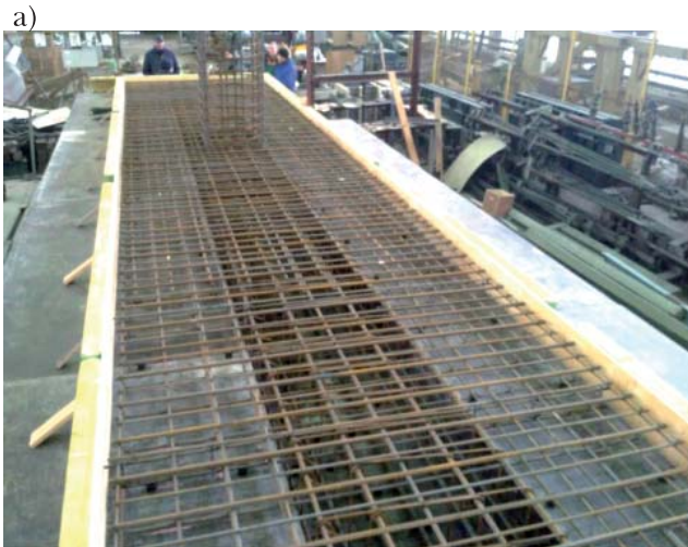
Рисунок 1 – Армування зразка балки: а) армування полиці б) армування опори-колони
