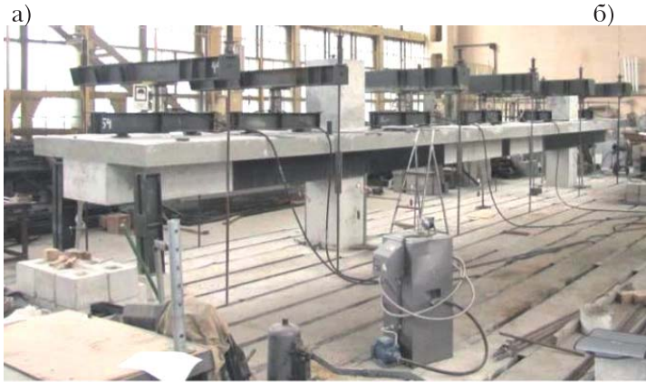
Рисунок 3 – Загальний вигляд зразка із підсиленням на стенді з навантажувальним обладнанням та вимірювальними приладами під час випробувань: а – з боків; б – знизу
