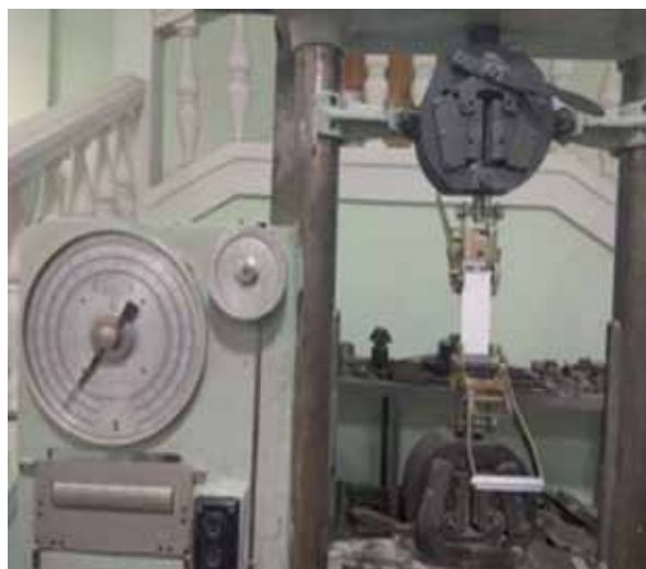
Рисунок 3 – Машина випробувальна УМ-5 для визначення розривного навантаження
