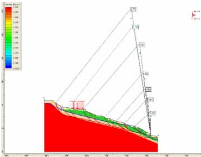
Рисунок 8 – Графічна схема зсувного схилу з усілякими поверхнями ковзання в програмному комплексі "SLIDE 5.0" компанії "Rocscience Inc" для оцінки загальної стійкості схилу при водонасичненні ґрунтів, що складають схил (ІГЕ-1, ІГЕ-2), зі сформованою поверхнею ковзання "плашка по плашці" зі змоченою поверхнею при виникненні сейсмічних навантажень до будівництва пальових підпірних стін
