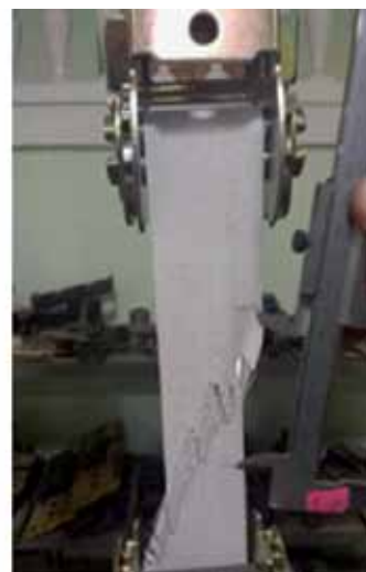
Рисунок 3 – Машина випробувальна УМ-5 для визначення розривного навантаження
