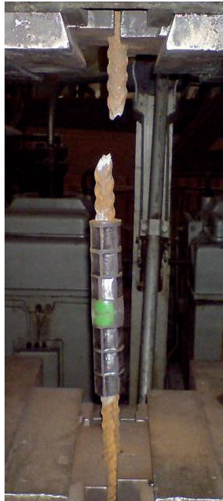
Рисунок 8 – Характер разрушения механических обжимных соединений
