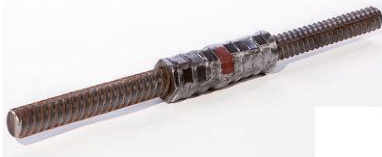
Рисунок 5 – Механическое соединение арматуры диаметром 28 мм, выполненное путем обжатия соединительной муфты
