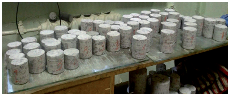
Рисунок 4 – Вигляд зразків-кернів бетону перед випробуваннями
