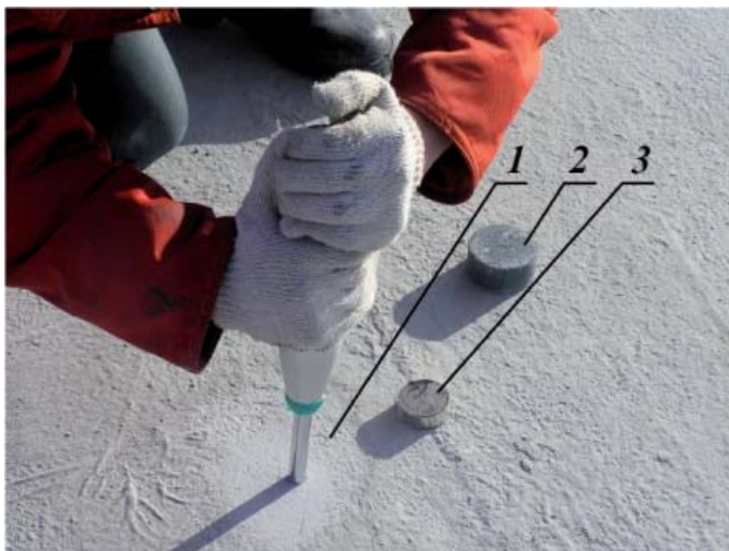
Рис. 2. Вимірювання міцності бетону склерометром:
