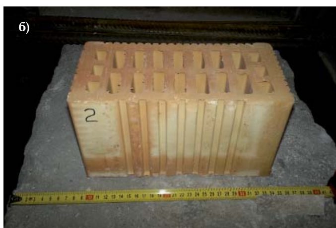
Рис. 3. Дія статичного вертикального навантаження на мурування: а) – схема роботи мурування під навантаженням; б), в) – дослідний зразок із пустотністю до випробувань та після них стискаючим навантаженням відповідно
