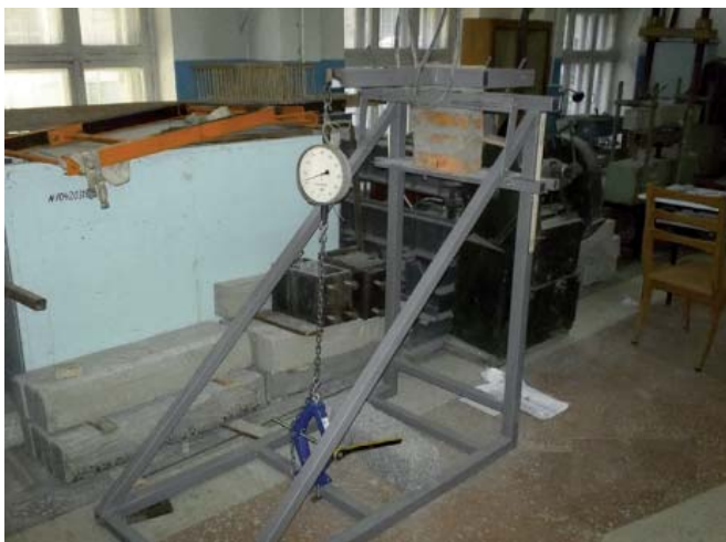
Рис. 5. Дослідний зразок мурування для визначення міцності зчеплення за методикою EN 1052-5:2005 та ASTM C1072
