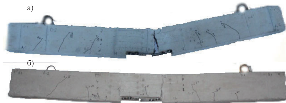
Рис. 4. Руїнування зразків серії 2 № 7 (а) та № 8 (б) з отвором діаметром 9,5 мм в арматурі, пошкодженими (до повного руїнівного) при рівні навантаження 0,5 від очікуваного руїнівного значення
