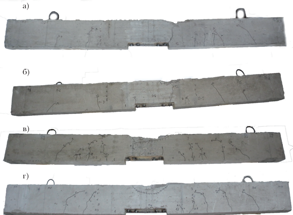
Рис. 2. Характер руйнування контрольних балок серії 1, зразки № 1 (а), № 2 (б) та серії 2, зразки № 1 (в), № 2 (г)
