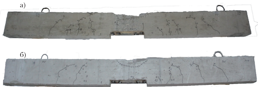
Рис. 3. Характер руйнування зразків серії 2 № 5 (а) та № 6 (б) з частковим пошкодженням розтягнутого армування отвором діаметром 5,6 мм, при рівні навантаження 0,5 від очікуваного руйнівного значення
