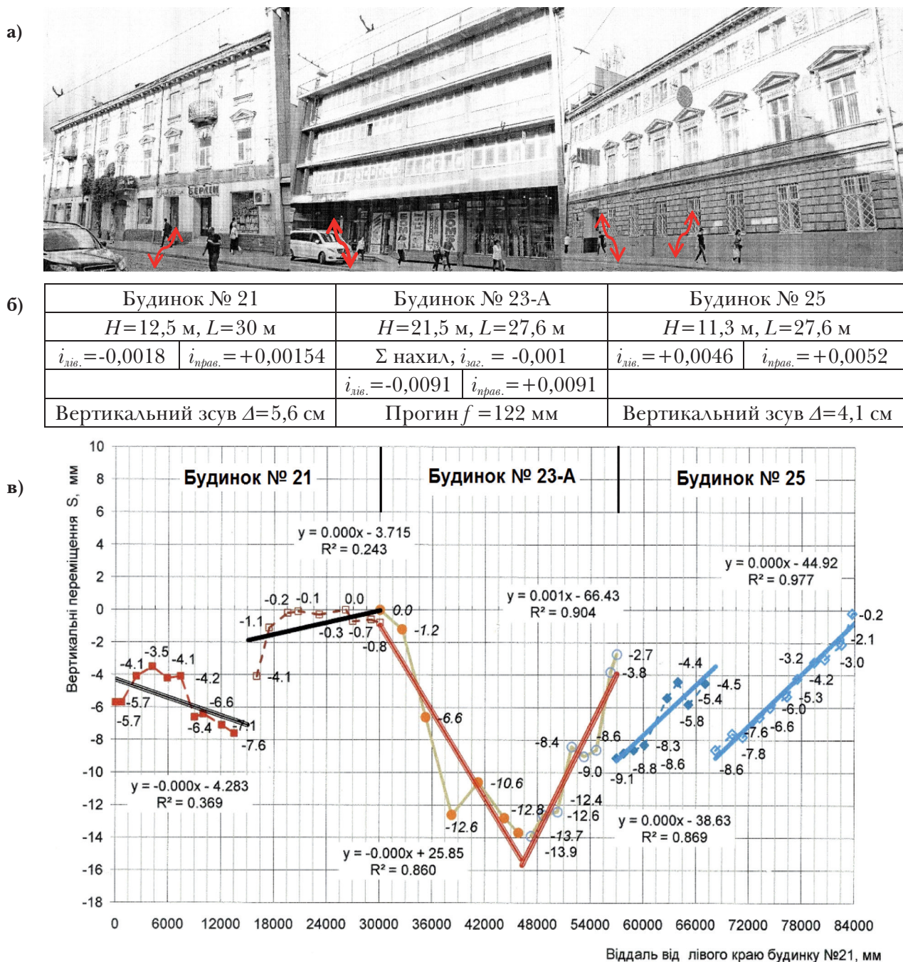
Рис. 3. Взаємовплив трьох будинків в умовах ущільненої забудови: а – фасади трьох будинків з позначеннями місць вертикальних зсувів ( \blacktriangledown ); б – значення параметрів деформування кожного будинку; в – зафіксовані показники відносних вертикальних переміщень кожного будинку
