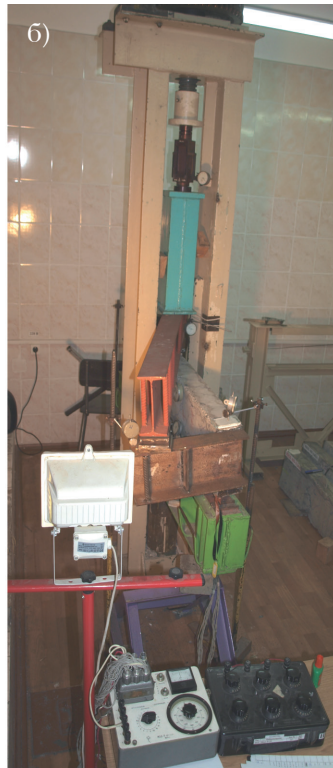
Рис. 2. Экспериментальная установка (с заданием деформационного воздействия) для проведения исследований железобетонных конструкций (в том числе составных) прямоугольного сечения при кручении с изгибом: а – фронтальный вид; б – боковой вид
