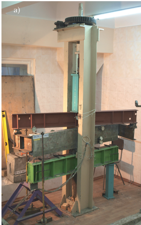
Рис. 2. Экспериментальная установка (с заданием деформационного воздействия) для проведения исследований железобетонных конструкций (в том числе составных) прямоугольного сечения при кручении с изгибом: а – фронтальный вид; б – боковой вид
