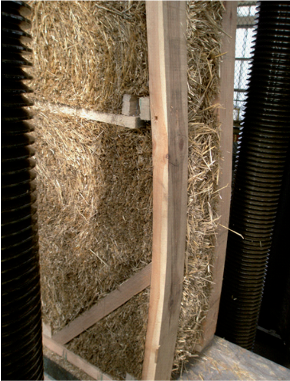
Рис.8. Руйнування зразка стінової панелі ПС-1 через втрату стійкості дерев'яної стійки.
