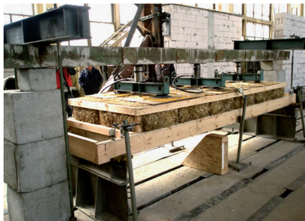
Рис.12. Загальний вигляд випробування панелі перекриття.
