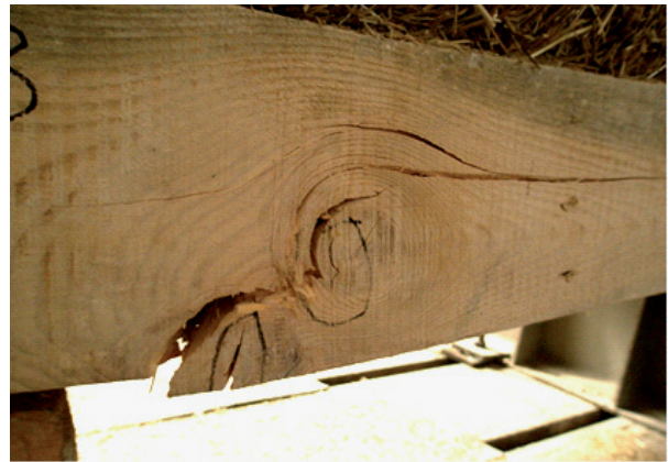
Рис.17. Характер злому по сучкам нижнього дерев'яного бруса зразка панелі перекриття ПП-2.
