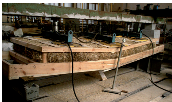
Рис.14. Руйнування зразка панелі перекриття ПП-1 через злом дерев'яного бруса посередині.
