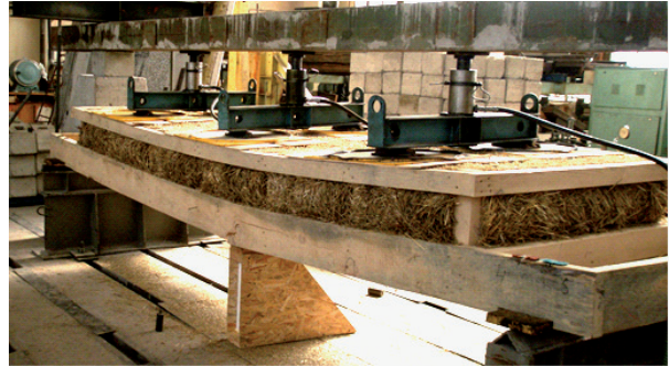
Рис.16. Руйнування зразка панелі перекриття ПП-2 через злом нижнього бруса на середині довжини.
