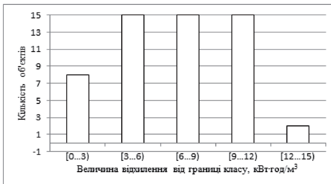
Рис.4. Відхилення об'єктів від лівої границі класу при умові, що R_{г,сер} , R_{s,сер} .
