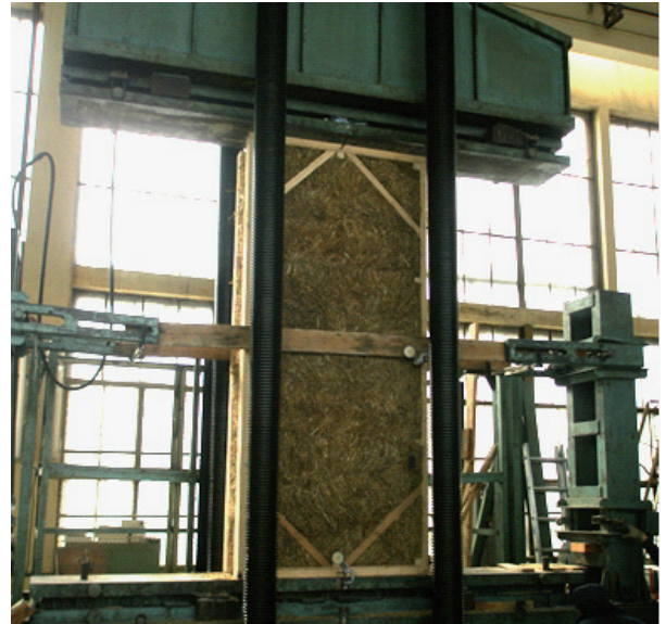
Рис.6. Випробування стінової панелі ПС на пресі ИПС-1000.
