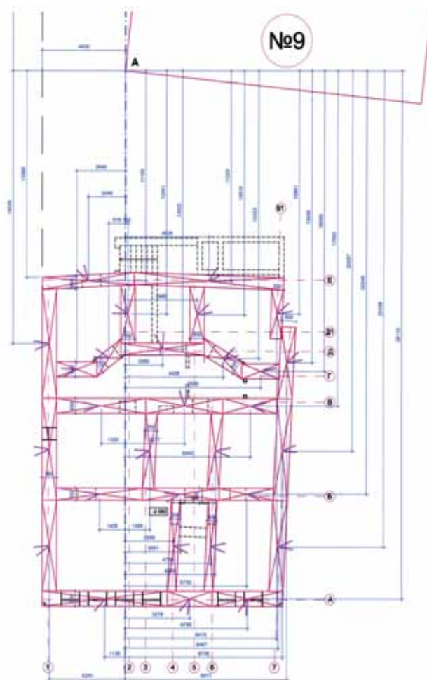
Рис.5. Прив'язка елементів підшов фундаментів існуючого будинку по вул. Джерельній, 69 до найближчого кута проєктованого будинку №9.
