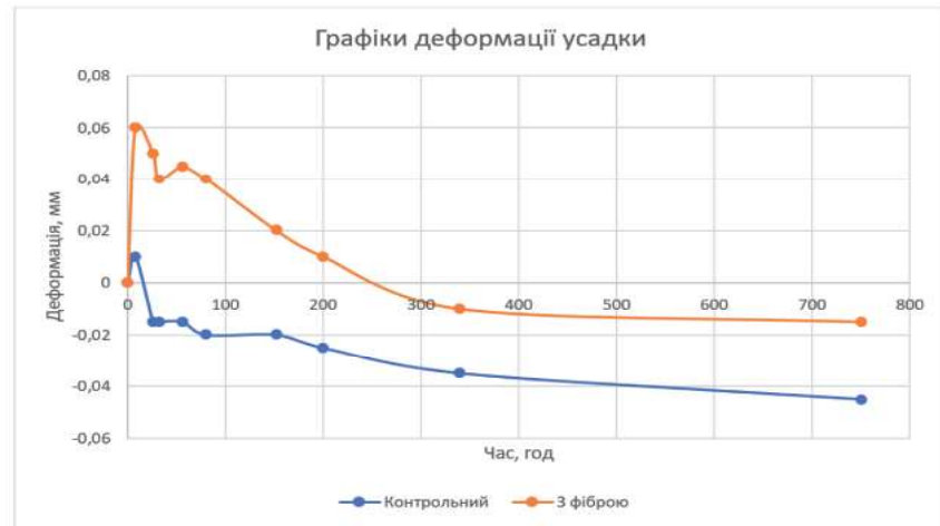
Рисунок 3 – Деформації усадки бетонів з і без фібри
