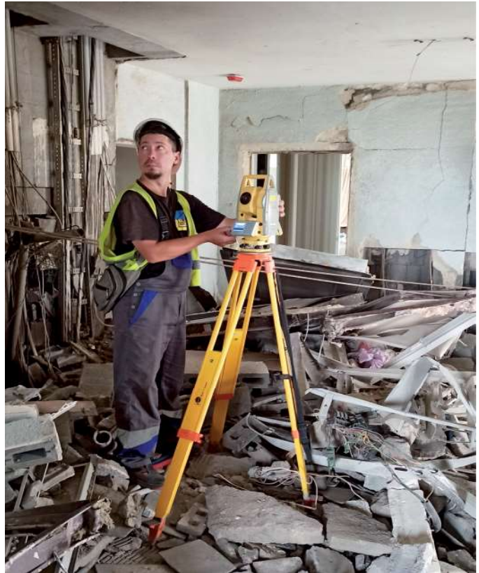
Рисунок 11 – Процес тригонометричного нівелювання у безвідбивачевому режимі
