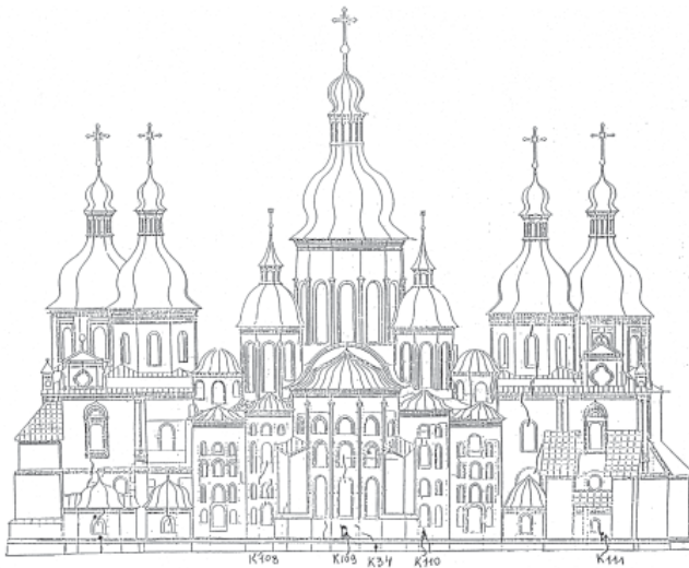
Рисунок 15 – Спостережна станція для замірів ширини розкриття тріщин на конструкціях Софійського собору (східний фасад)
