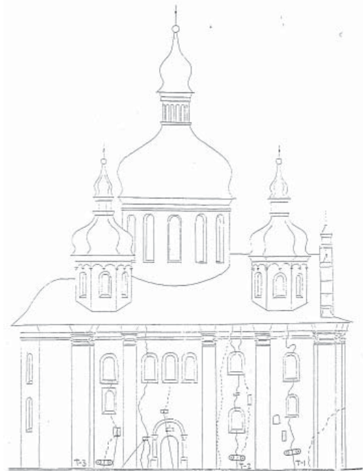
Рисунок 16 – Спостережна станція для замірів ширини розкриття тріщин на конструкціях Кирилівської церкви (північний фасад)
