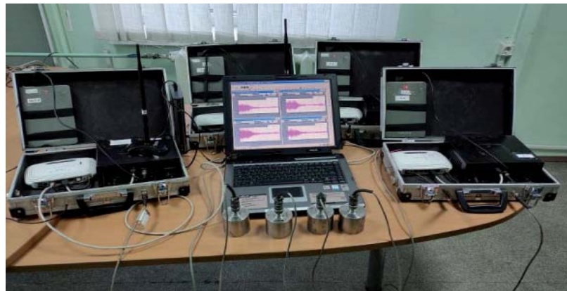
Рисунок 4 – Загальний вигляд багатоканальної системи моніторингу будівельних конструкцій «Сейсмомоніторинг»
