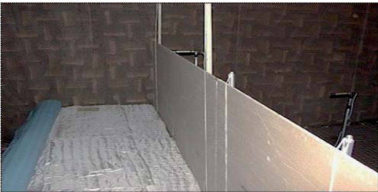
Рисунок 18 – Експериментальні дослідження акустичної ефективності шумозахисних екранів в заглушеній камері (на фізичних моделях)
