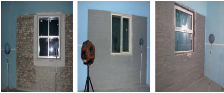
Рисунок 16 – Випробування звукоізоляції світлопрозорих конструкцій
