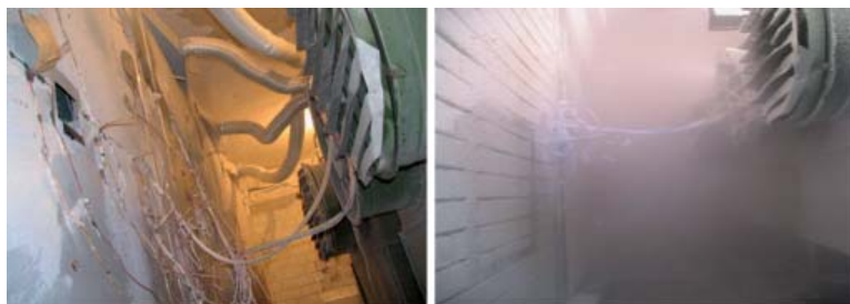
Рисунок 8 – Проведення досліджень показників теплової надійності конструкцій фасадної теплоізоляції у кліматичній камері
