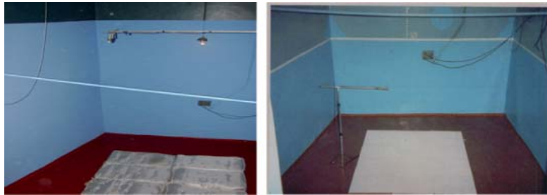
Рисунок 13 – Вимірювання звукопоглинальних характеристик матеріалів в звукомірній ревербераційній камері
