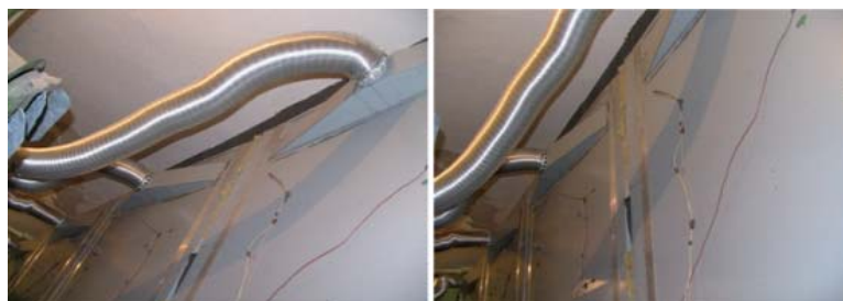
Рисунок 7 – Система забезпечення необхідних витрат повітря в прошарку конструкцій під час випробувань в кліматичній камері
