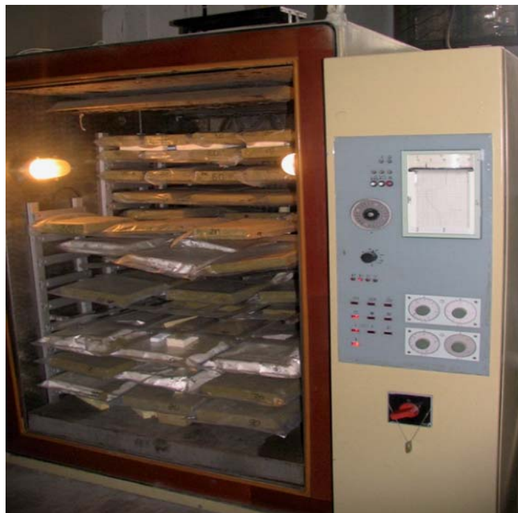
Рисунок 6 – Вид кліматичних камер із дослідними зразками для випробувань показників теплової надійності
