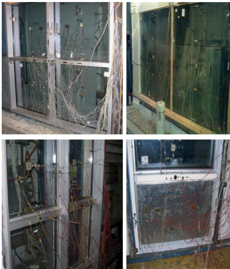
Рисунок 4 – Дослідження світлопрозорих огорожувальних конструкцій у кліматичній камері
