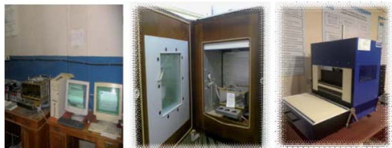
Рисунок 10 – Вид експериментальних установок для випробувань теплопровідності будівельних матеріалів в залежності від температури
