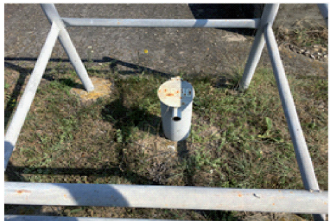
Рисунок 7 – Опускні п'єзометри на лівобережній греблі з ґрунтових матеріалів Дністровської ГЕС-2 на буферному водосховищі
