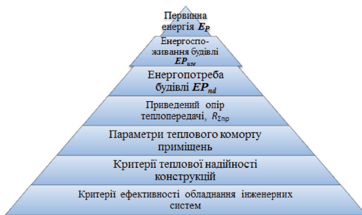
Рисунок 2 – Структура критеріїв енергоефективності будівель
