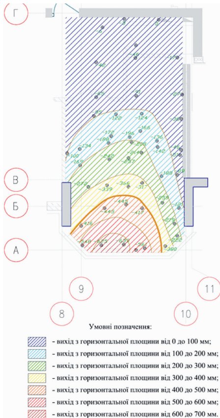
Рисунок 17 – Результати визначення відхилень від умовної горизонтальної площини перекриття 12-го поверху житлового будинку по вул. В. Чорновола, 15А, м. Чернівці
