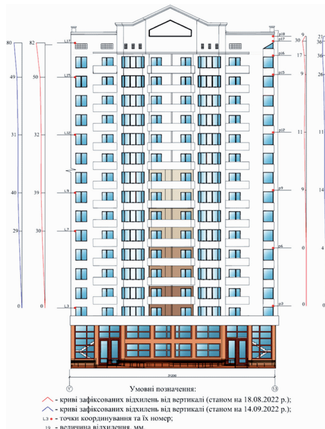
Рисунок 11 – Результати визначення відхилень від вертикалі граней кутів стін будівлі в осях 1'–13 по вул. В. Чорновола, 15А, м. Чернігів
