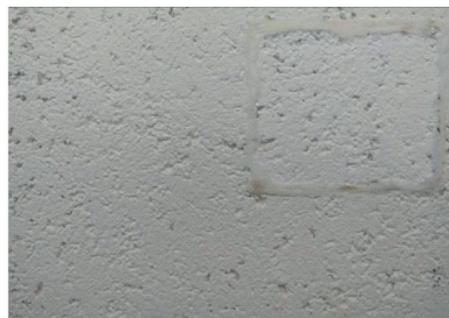
Рисунок 5 – Зовнішній вигляд дослідних зразків після II-го етапу випробувань на циклічні кліматичні впливи
