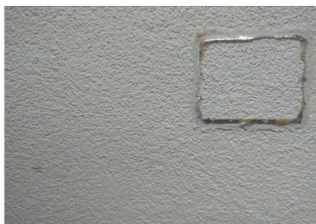
Рисунок 5 – Зовнішній вигляд дослідних зразків після II-го етапу випробувань на циклічні кліматичні впливи
