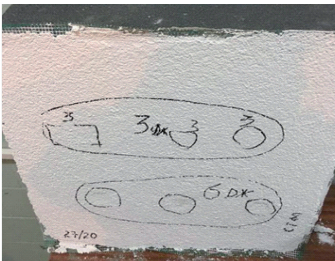
Рисунок 8 – Загальний вигляд базового покриття дослідного зразка після дії удару 3 Дж, 6 Дж (а – пінополістирольні плити, б – мінераловатні плити)
