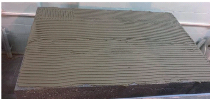
Рисунок 1 – Зразки комплектів у кліматичній камері виготовлених при температурі мінус 10^{\circ}\text{C}
