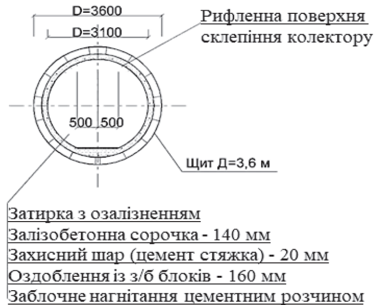
Рисунок 2 – Конструкція каналізаційного колектору
